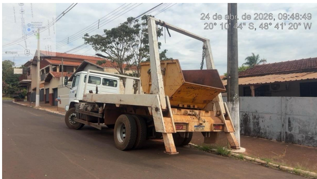
Figura 37: O Caminhão (Poli Guindaste) da empresa contratada serviço de limpeza pública (distribuição e coleta de caçambas) material recolhido destinado na área de transbordo de entulho Prefeitura de Colômbia-SP.
